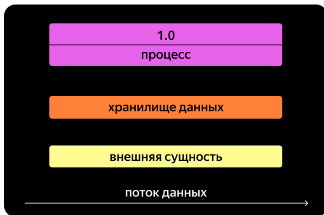
Рис. 5. Четыре компонента диаграммы DFD: внешняя сущность, хранилище данных, процесс и поток данных
